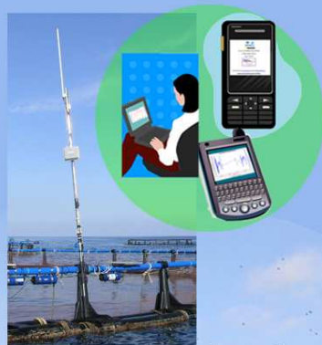
Fig 1. Sistema de transmisión telemétrico de transmisión inalámbrica que envía la información registrada por las unidades de medición. El usuario puede acceder a la base de datos vía web, teléfono móvil o PDA
